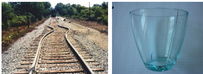
Рис. 1: Разрушение изделий (а) и материалов (б) вследствие их термического расширения
