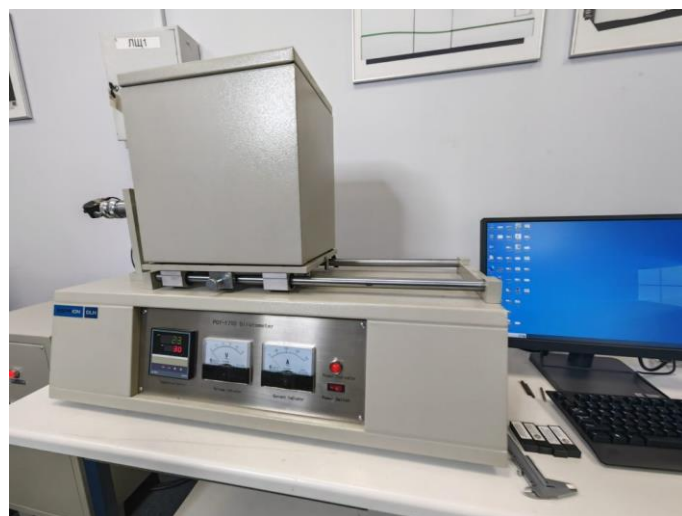
Рис. 3: Горизонтальный дилатометр INSPIRION DLH
