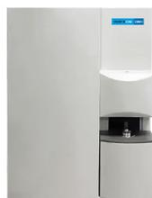
INSPIRION ONH (анализ кислорода, азота и водорода в металлах, сплавах, керамике, стекле и солях)
