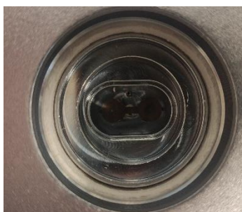
Рис 1. Печь калориметра DSC200 с сенсорами теплового потока
