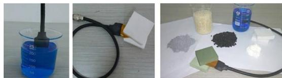
Рис. 1: Сенсор Smart TCM Hot Disk и примеры анализа жидкости, твердого материала и стекла
