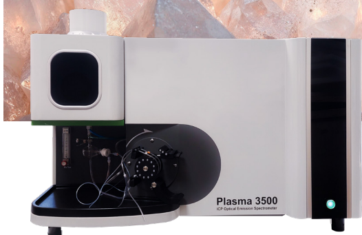
Оптико-эмиссионный спектрометр с индуктивно-связанной плазмой Plasma 3500.
