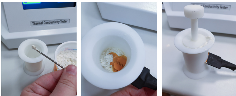
Рис. 3: Подготовка проб муки к измерению коэффициента теплопроводности и температуропроводности
