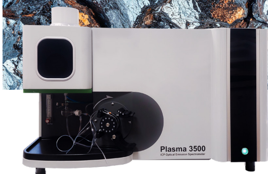
Опτικο-эмиссионный спектрометр с индуктивно-связанной плазмой Plasma 3500.
