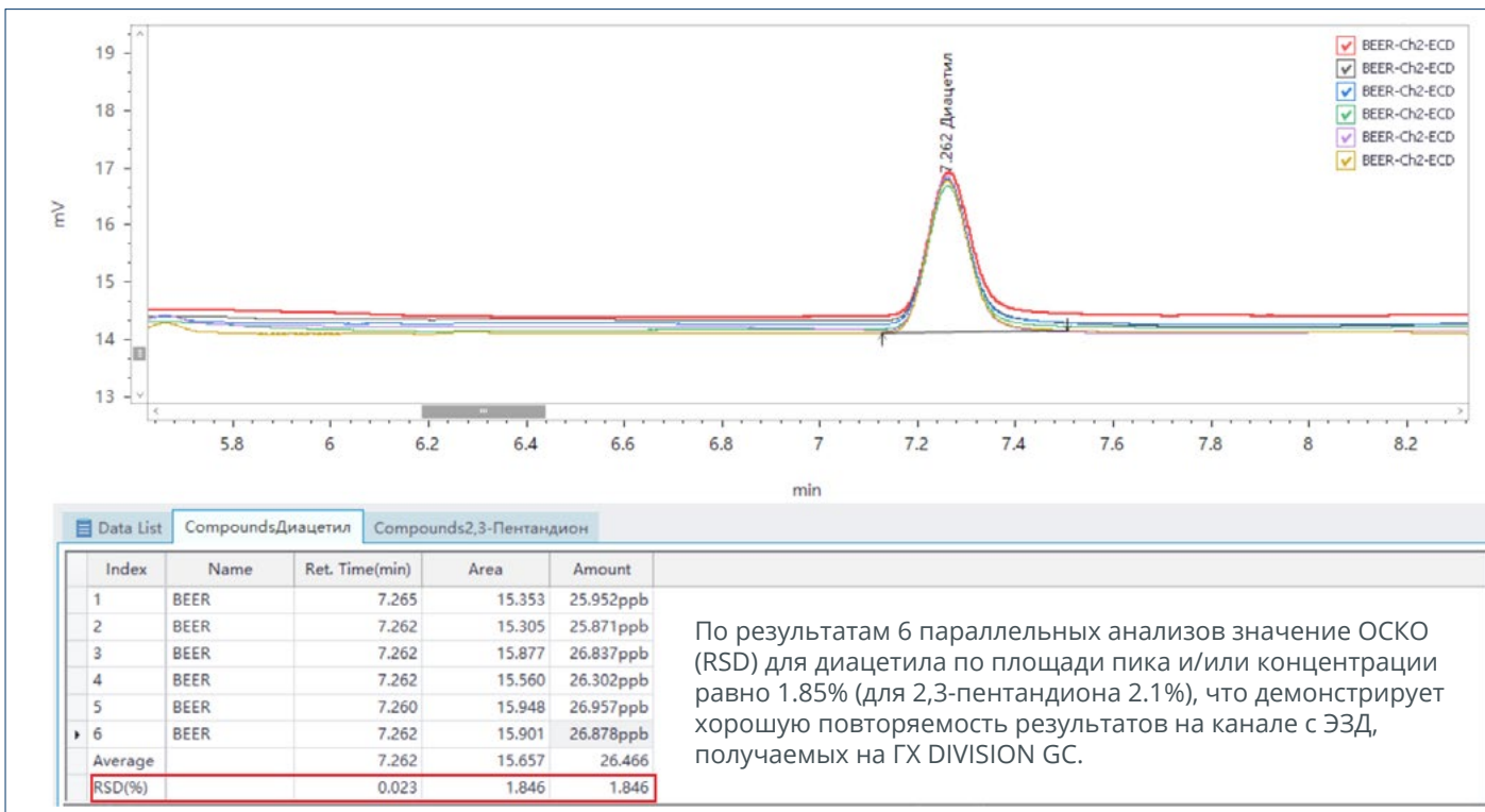
Повторяемость результатов. Шесть хроматограмм пива с концентрацией диацетила 26.5 ppb
