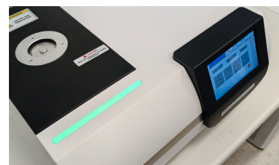
LED-панель индикации состояния прибора и сенсорный экран дисплей
